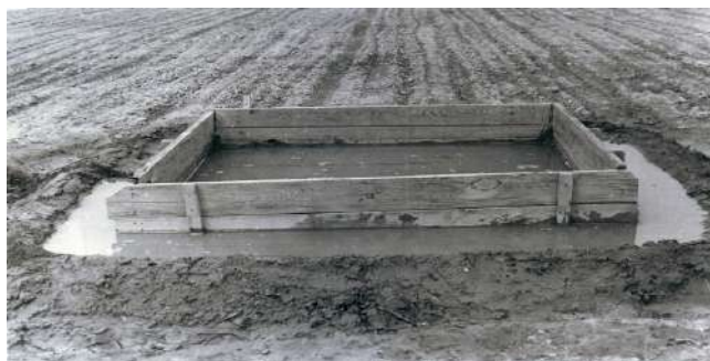
1-rasm. Tuproqning cheklangan dala nam sig'imini kvadrat ramka usulida aniqlash.
