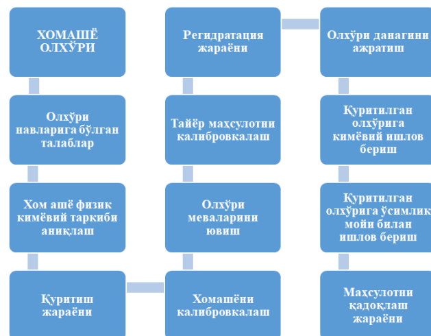
1-Расм. Олхўри мевасини қуриштиш технологик схемаси.
