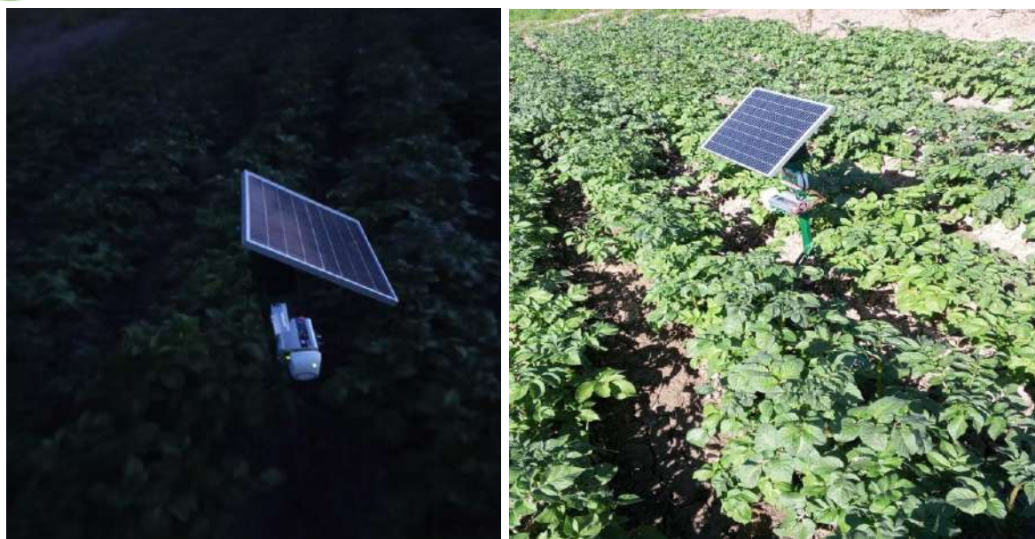
3-rasm. Quyosh batareyasi bilan taminlangan ultratovish tarqatish qurilmasi.
