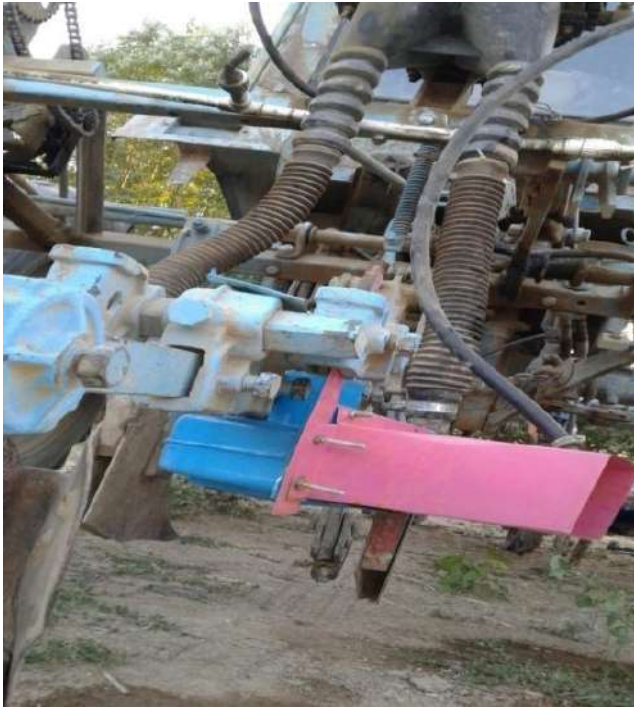
1-rasm. Ventilyatorli suspenziya purkagich moslamasi KXY-4A kultivatoriga o‘rnatilishining umumiy ko‘rinishi
