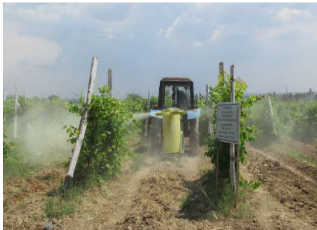
Рис.2 Опыливатель широкозахватный универсальный ОШУ-200 М. в агрегате с трактором Беларусь 82.1 в работе.
