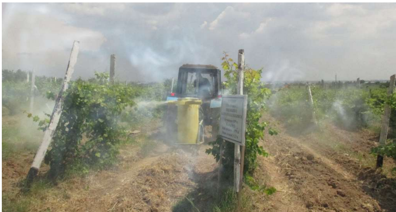
Рис.1 Опыливатель ОШУ-200М в агрегате с трактором Беларусь 82.1 в работе (вид сзади).
