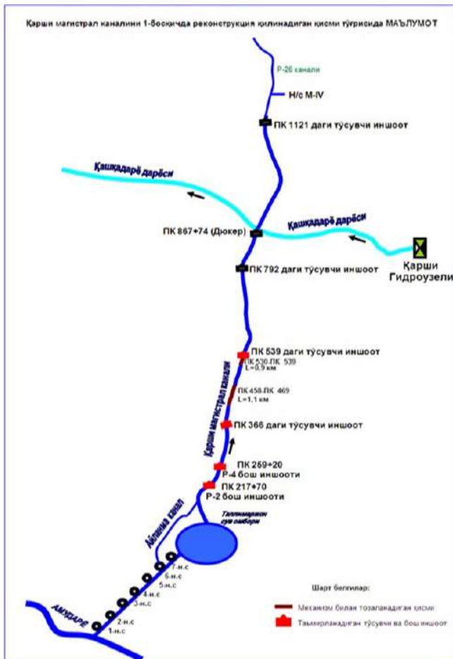
1-расм. Қарши магистрал каналининг Амударё ўзанидан сув олиш схемаси
