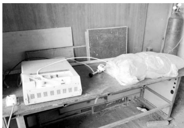
Рисунок 2 - Обработка семян хлопчатника озонно-кислородной смесью
