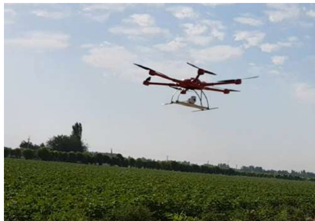
1-расм. Трихограммани тарқатиш қурилмаси орқали ғўза майдонида тунлам тухумларига қарши трихограммани тарқатиш
