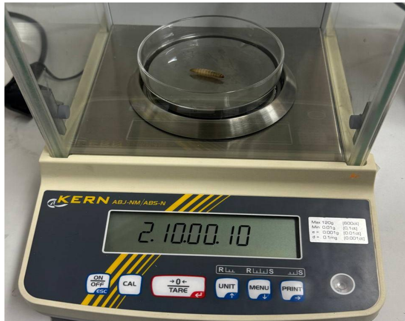
4-rasm. Ishlab chiqilgan oziqada ko'paytirilgan mum kuyasi ( Galleria mellonella ) 6-yoshdagi qurtining elektron tarozidagi vazni. (2021-2025 yy. TDAU laboratoriya tajribalari. (KERN abj-nm/abs-n elektron tarozisida bajarildi).
