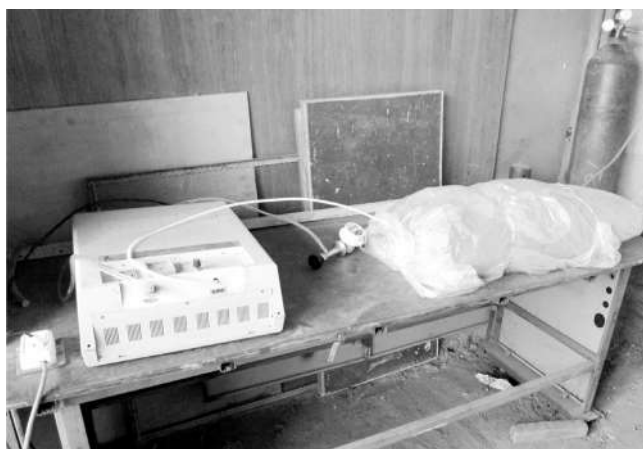
Рисунок 2 - Обработка семян хлопчатника озонно-кислородной смесью
