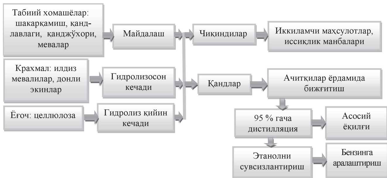
1-расм. Турли хилдаги хом-ашёлардан биоэтанол ишлаб чиқаришнинг умумий технологик схемаси
