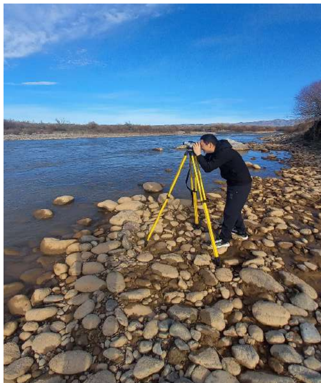
1-расм. GPS ва АТ - 32 оптик нивелир қурилмаларида геодезик тадқиқотлар.
