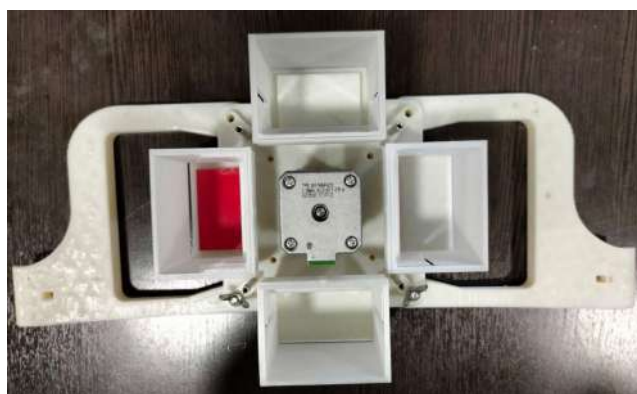
С применением технологии аддитивного производства, а именно 3D печати, были созданы трехмерные модели деталей для первого прототипа и напечатаны с помощью аддитивного производства (Рисунок 2).
