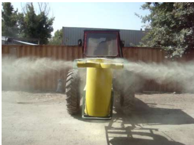
Рис.1 Опыливатель широкозахватный универсальный ОШУ-200 М. в агрегате с трактором ТТЗ-80.11 в работе.
