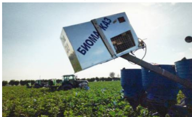
Рисунок-2. Устройства для расселения трихограммы воздушным аэродинамическим способом прикреплённый к тракторному агрегату (Букинский район, Ташкентская область).
