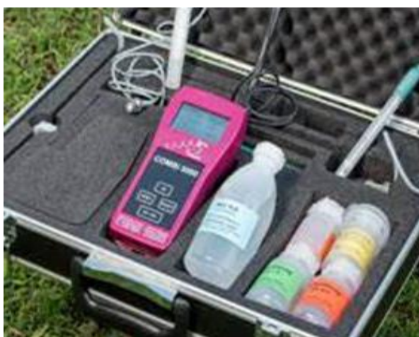
1-rasm. Germaniyada ishlab chiqarilgan tuproq va suvning sho'rlanish darajasini tezkor aniqlovchi – elektrokonduktometr (COMBI 5000)
