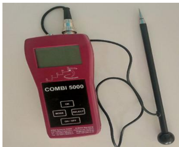
1-rasm. Germaniyada ishlab chiqarilgan tuproq va suvning sho'rlanish darajasini tezkor aniqlovchi – elektrokonduktometr (COMBI 5000)
