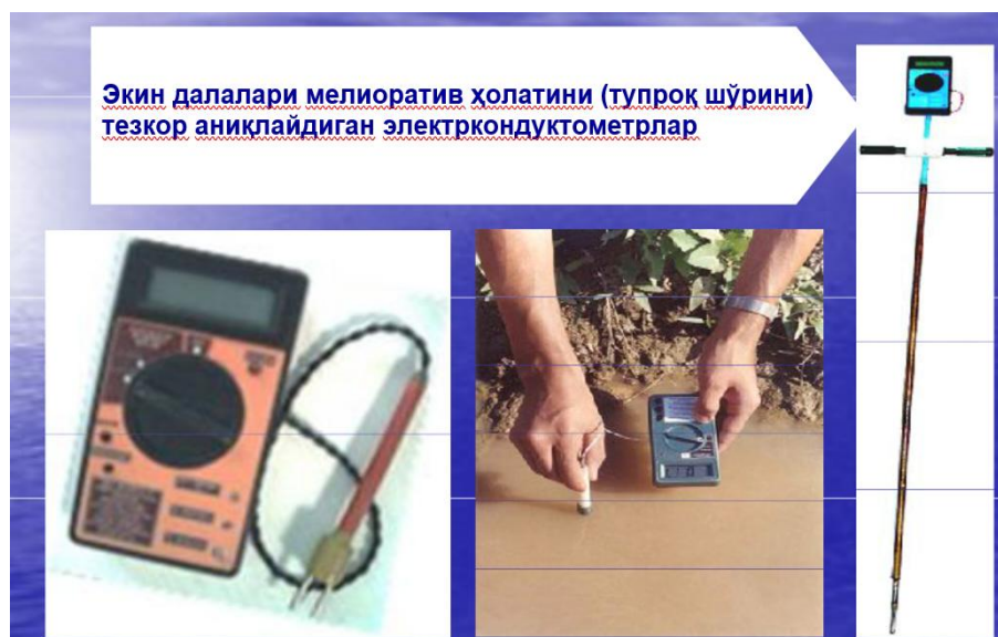
3-rasm. O'zbekistonda ishlab chiqarilgan tuproq va suvning sho'rlanish darajasini tezkor aniqlovchi-elektrokonduktometr.
